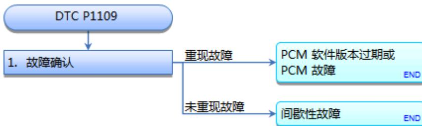
**DTC P1109: BARO 传感器电路超出范围过高**注意: 排除故障前, [查看一般故障排除信息](#)。
